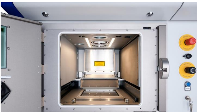
SLM Solutions Group AG 制造的选择性激光设备 Melting Maschine SLM280 2.0 的工艺室
