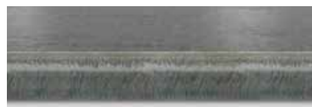
使用氮氧混合气体进行激光切割
