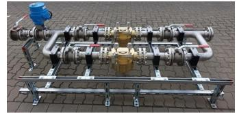
根据客户需要,可以在输入端中使用电机控制的闭锁装置,以实现完全关断。另外,应在每个调节器前后设置手动闭锁装置,便干将支路抽真空。
