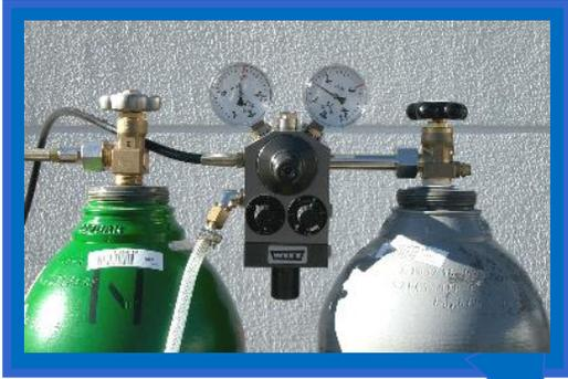
这样一来就不再需要不同的混配气体成品了，因为使用氩气瓶和二氧化碳气瓶就可以生产所需的混配气体，二氧化碳的混配比例为0-25%，剩余部分为氩气。气体混配器可以方便地通过标准接口进行连接，借助标准扳手可以将混配器接口的螺母与气瓶阀相连。操作简单方便，通过标准软管可以为焊接源输送保护气，通过打开气瓶阀可以运行气体混配器，通过压力表可以读取产生的压力。因为气体混配器拥有集成的压力调节控制器以及安全阀，因此也不再需要额外的气瓶减压阀。
