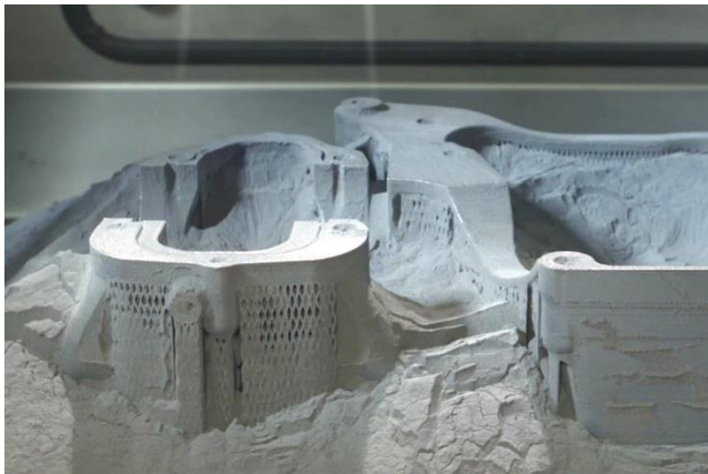
Composant imprimé en 3D fait à partir de poudre de métal dans la chambre de traitement d'une machine de fusion laser sélective SLM500 de SLM Solutions Group AG
