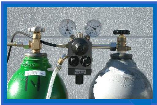
In diesen Fällen wird mit Flaschengas gearbeitet, dass der Schweißquelle zugeführt wird.
