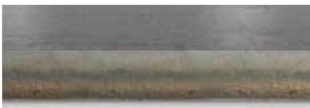
O 2 를 이용한 레이저 절단
