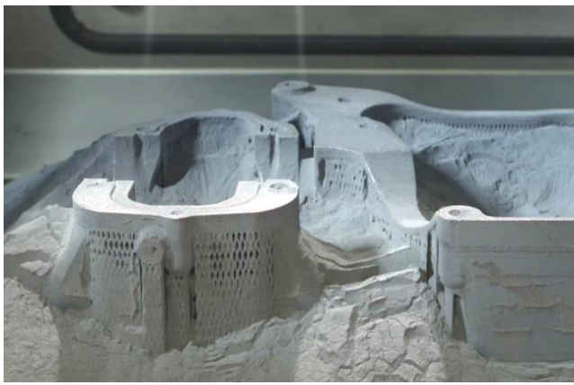
SLM Solutions Group AG의 선택적 레이저 용융 기계, SLM 500 프로세스 챔버에서 금속 파우더로 제조된 3D 프린트 부품.
