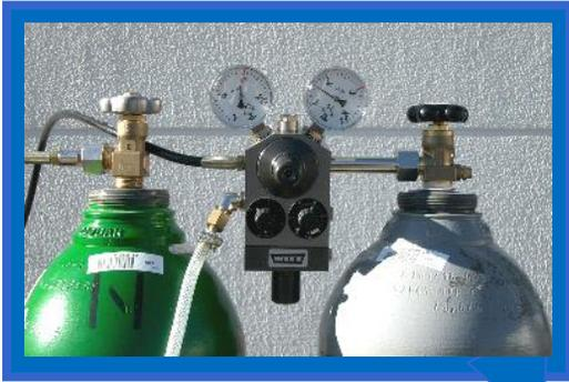
이러한 경우 용접 작업장에 직접 전달되는 로컬 공급 가스를 사용합니다. 용접작업이 진행되는 현장에서의 소형 가스혼합기 사용이 점점 늘고 있습니다.
