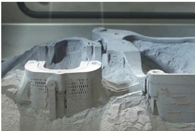
Komponent drukowany 3D wykonany z proszku metalowego w komorze procesowej maszyny selektywnego topienia laserowego SLM500 prod. SLM Solutions Group AG
