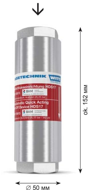
Быстрозапорный клапан компании WITT для надежной защиты от взрывоопасного распада ацетилена в напорных трубопроводах систем подачи ацетилена, соответствуют стандартам EN ISO 14114.
